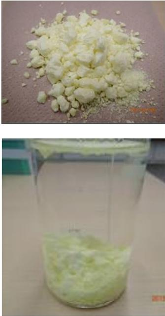
図4. 粗砕硫黄の外観（上）と水中での沈降状況（下）
