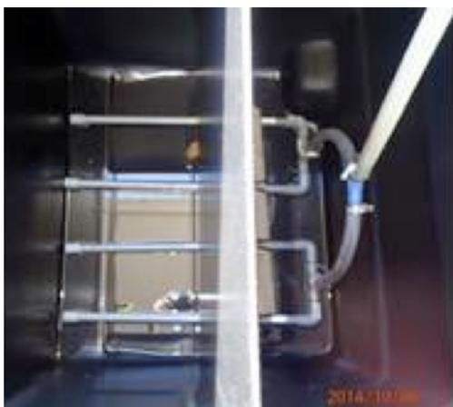
図 13. 有孔塩ビ管を用いた曝気逆洗装置
