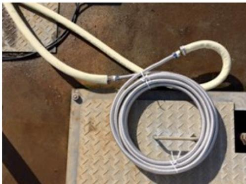
図7. 曝気槽に浸漬させる水道用ステンレスフレキシブル管
