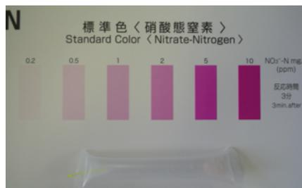
図 11. パック試薬法による硝酸性窒素の測定
